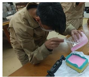
写真6 シリコンをクッキーオス型へ流し込みの様子
