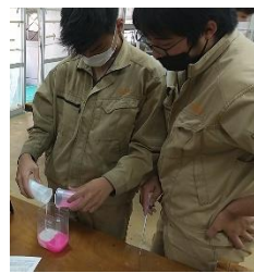
写真6 シリコンをクッキーオス型へ流し込みの様子
