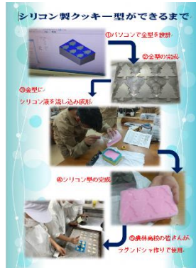
写真24・25 シリコン型作成手順と南部工業生の紹介
